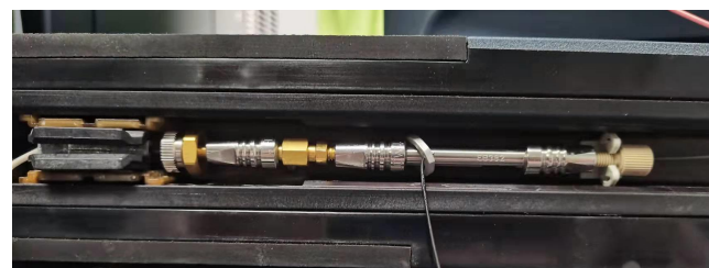
在色谱柱洗脱下，样品依次到达探针，再经过锥孔到达质谱内部
