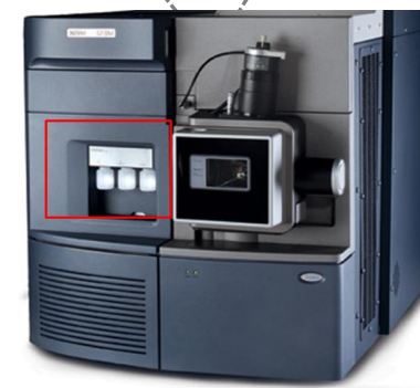
在色谱柱洗脱下，样品依次到达探针，再经过锥孔到达质谱内部
